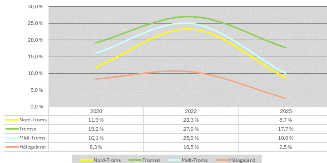
Andel kritisk og svært dårlig dekketilstand i Troms fylke på lav-ÅDT veger med asfalt
