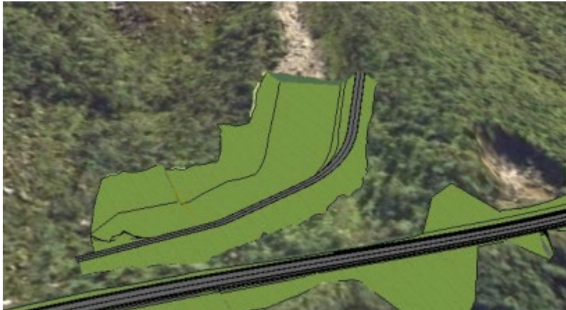
Ledevoll ved skredpunkt under Breitinden
