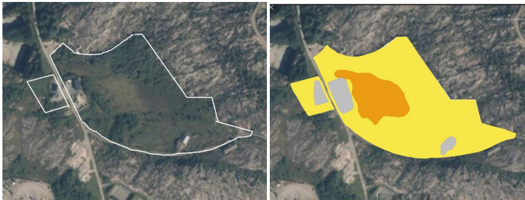
Figur 28 Her vises flyfoto sammen med konsekvensvurderingen av områdene. Deler av arealet som er aktuelt for antennepark består av myr (oransje farge). Det anbefales at antennene settes opp utenfor myra og på en slik måte at myra ikke dreneres ut.
