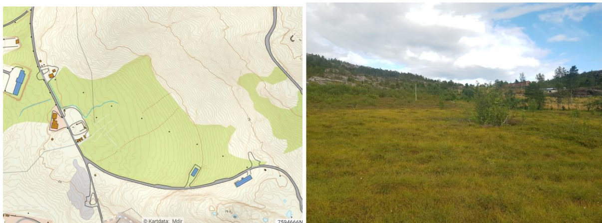
Figur 27 Området der det er ønske om å bygge en antennepark er det grønne området nord for veien i kartet. Høydekurvene viser at dette er i hellende terreng. På bildet tatt under befaringen i august 2023 ser vi at en del av området er myr. Dette arealet bør unngås ifm. oppsetting av en antennepark. Området mot veien i øst var nylig hogget, og for å ta mest mulig naturhensyn bør antenneparken konsentreres til området nærmest veien i sørøst der det nylig har vært hogget.
