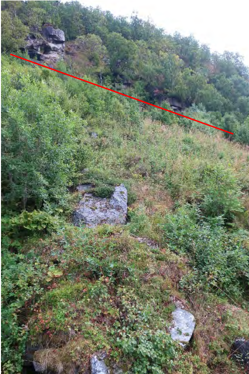
Foto 6: Urområde mellom profil 17320-17500. Dette er fra første del av uområdet. Den røde linjen indikerer fast fjell.
