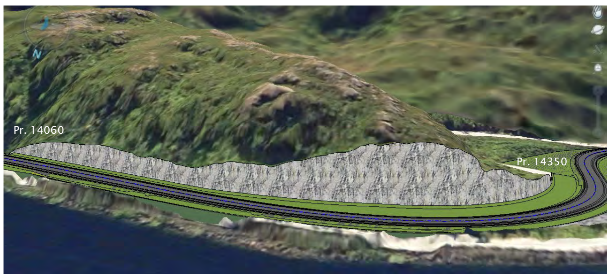
Figur 4: Bergskjæring videre langs Storvatnet mellom ca. pr. 14060-14350 i linje 15500.
