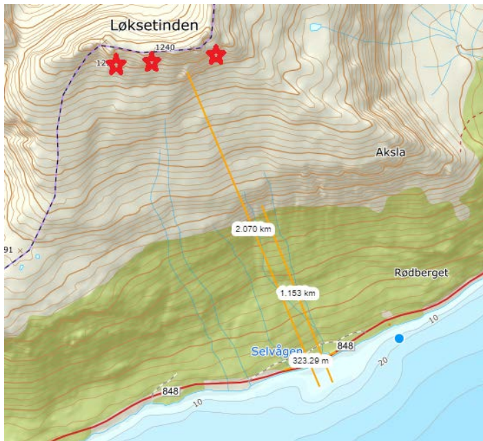
Figur 11 – Avstander fra mulig radar-punkt til løsneområdene, og kjøreavstand gjennom strekningen hvor skred normalt når veg. Potensielle nedsprenkningstårn er også skissert inn.
